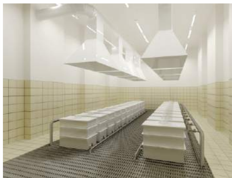
ВАННА ГАЛЬВАНИЧЕСКАЯ из полипропилена
